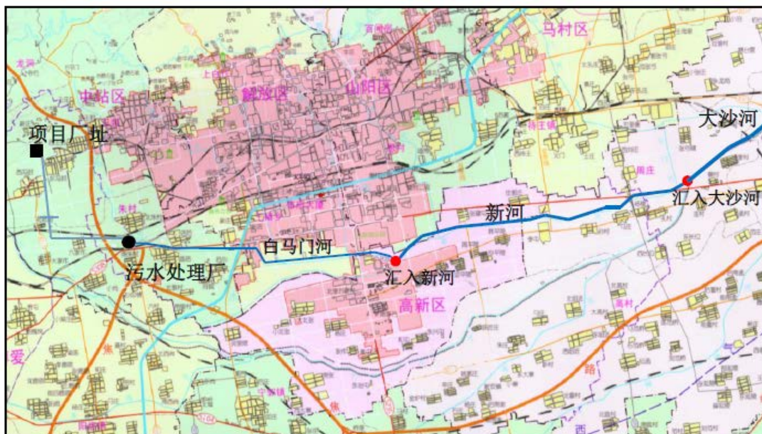
图 5.2-1 工程区域水系分别及排水去向示意图
